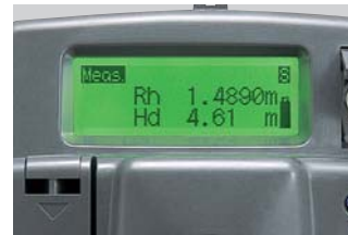
DL-500の場合、スタッフのコードを自動的に読み取り、正確な測定値を即座にデジタル表示。
