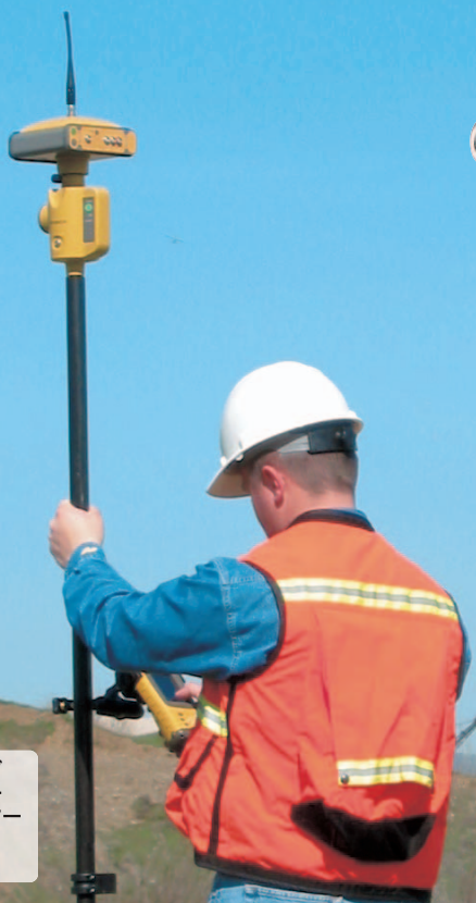
測量用 ポジショニング ゾーンセンサー PZS-1
