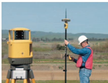
ポジショニング ゾーンレーザー トランスミッター PZL-1
