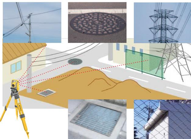
超小径スポット測距は、壁の角や入射角が浅くなる路上のマンホール、送電線などを高い精度で直接測定できるうえ、格子状や網状のフェンス越しの測定にも圧倒的に有利。
